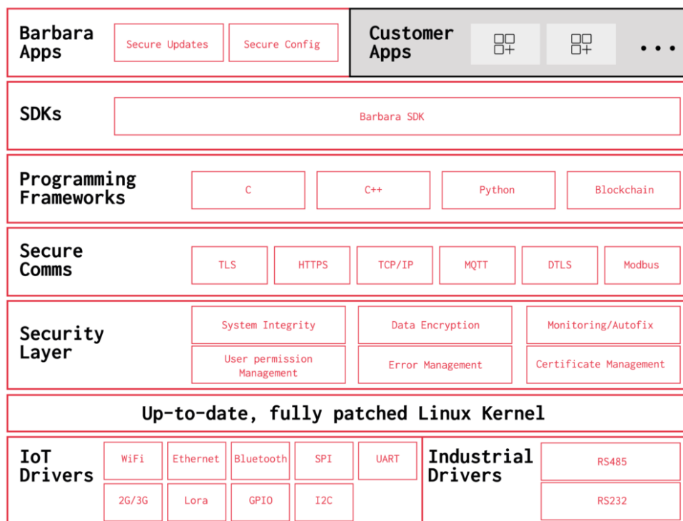
Рисунок 2.6 – Структура модулів програмного забезпечення пристроїв IoT під управлінням OS на прикладі Linux дистрибутива Barbara OS
