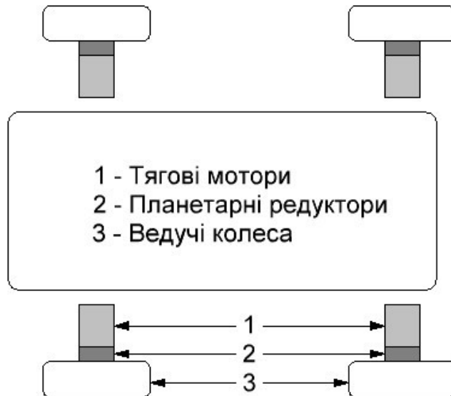
Рисунок 1.1 – Схема ЕП з приводом на всі колеса
