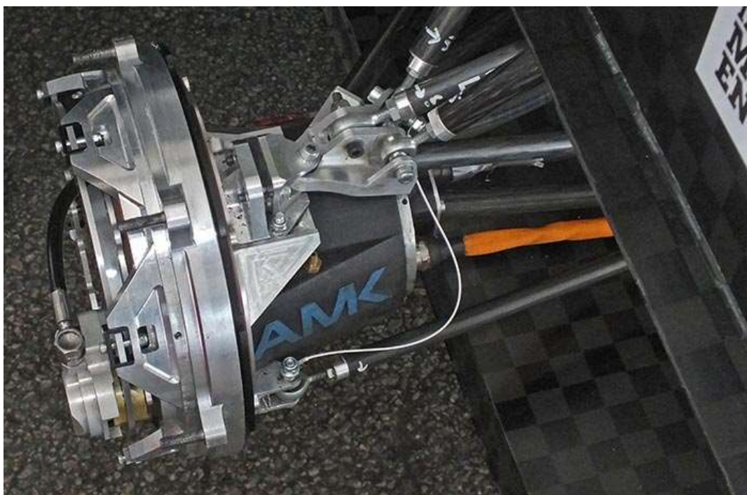
Рисунок 1.2 – Система мотор-редуктор-колесо на боліді TU Delft
