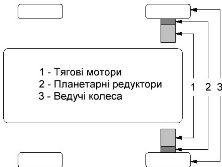
Рисунок 1.3 – Схема індивідуального ЕП задньої осі
