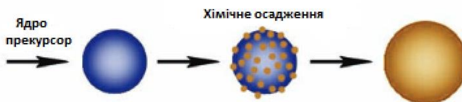
Рисунок 1.12 – Схематичне зображення формування оболонки методом хімічного осадження [89]
