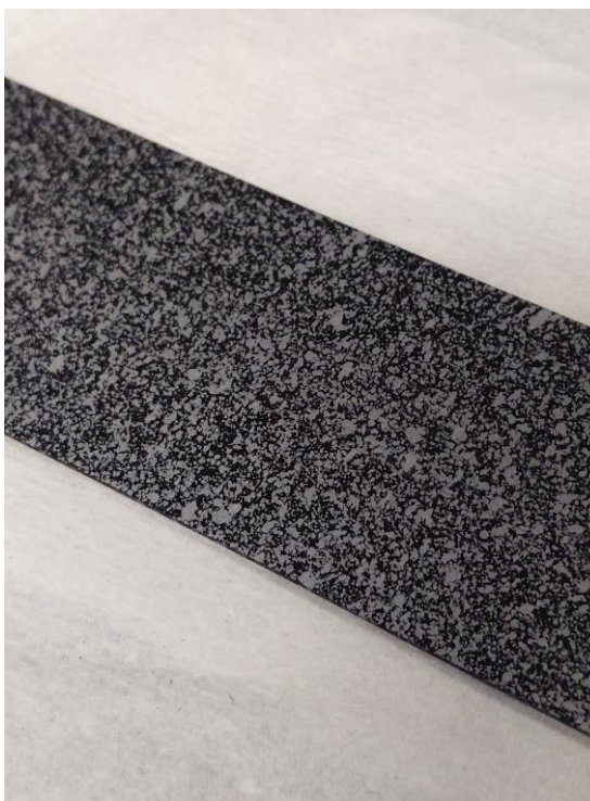
Рис.18 Застосований стохастичний спекл-візерунок
