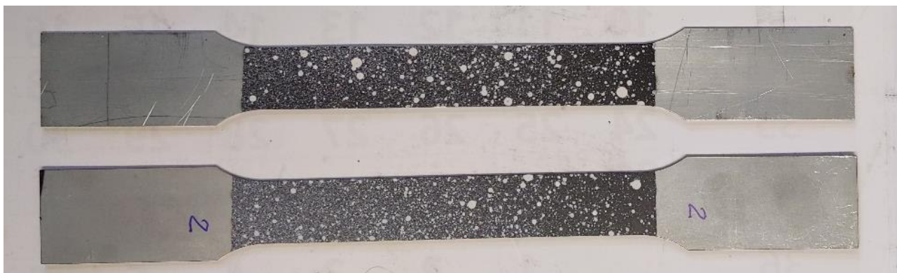
Рис. 27 Зразки на розтягування для вимірювання DIC
