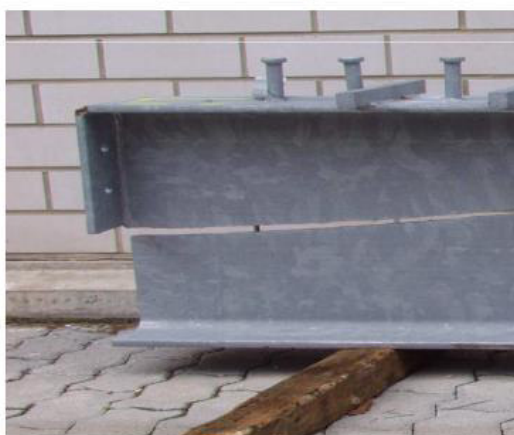
Рис. 1 Тріщина, спричиненим рідким металом та його макроскопічне зображення
