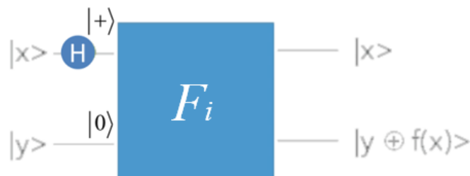
Рис. 6.10 – Дія оракула F_i на стан системи після застосування вентиля Адамара.
