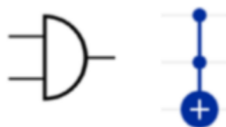
Рис. 4.25 – Еквівалентність вентилів AND та Тоффолі.
