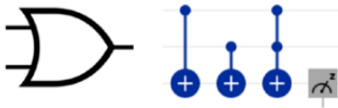
Рис. 4.27 – Еквівалентність вентиля OR та квантових вентилів.
