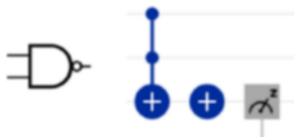
Рис. 4.28 – Еквівалентність вентиля NAND та квантових вентилів.
