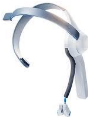
Рис. 1.1. Вигляд бездротової гарнітури MindFlex з 2 електродами, одним на чолі іншим на мочці
