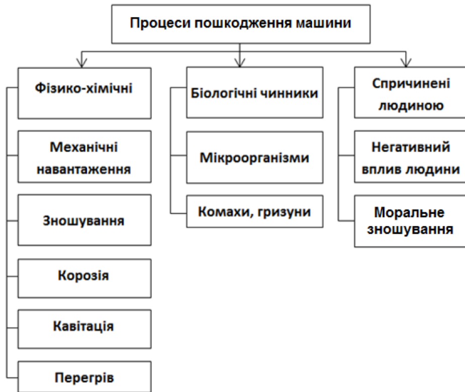
Рис. 13.6. Процеси, що зумовлюють пошкодження машини.
