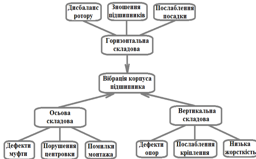
Рис. 10.5. Причини поперечних вібрацій турбіни.
