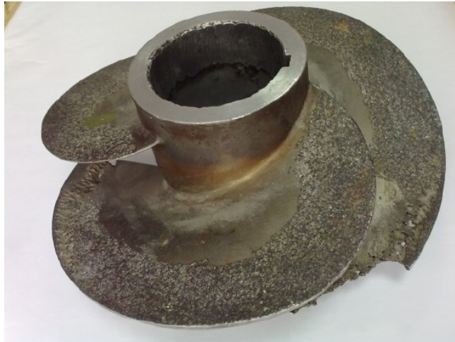
Рис. 13.4. Кавітаційне зношування робочого колеса насоса.
