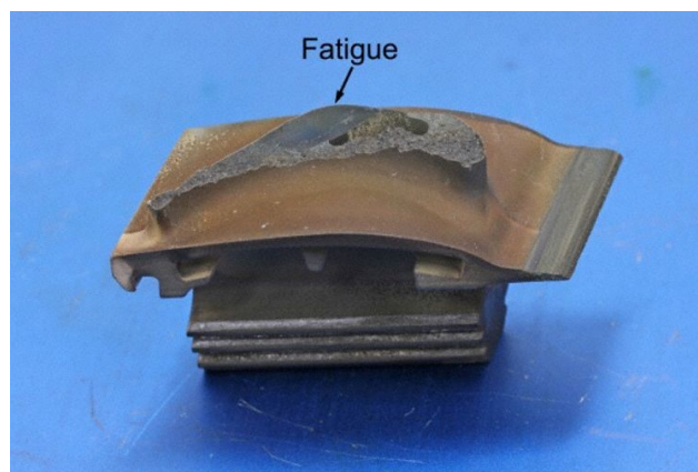
Рис. 6.5. Тріщина втоми у лопатці турбіни.
