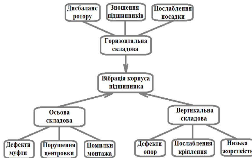
Рис. 12.4. Причинно-наслідкові зв'язки появи вібрації у корпусі підшипника.
