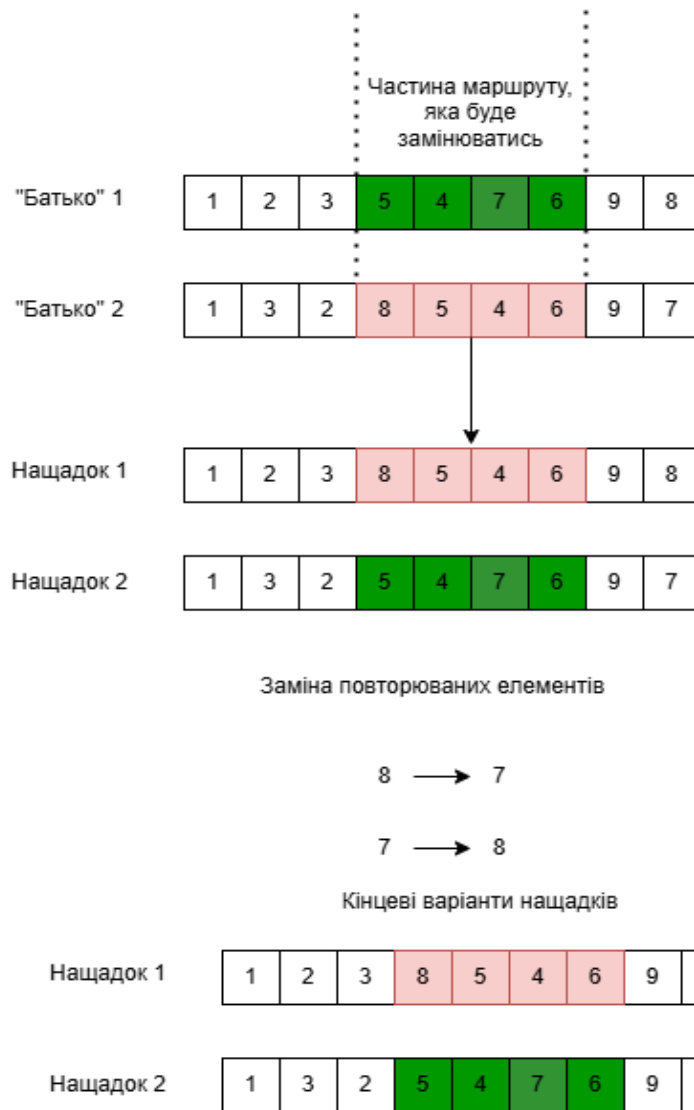
Рисунок 3.2 – Принцип роботи оператора схрещування, який використовується в гібридному алгоритмі
