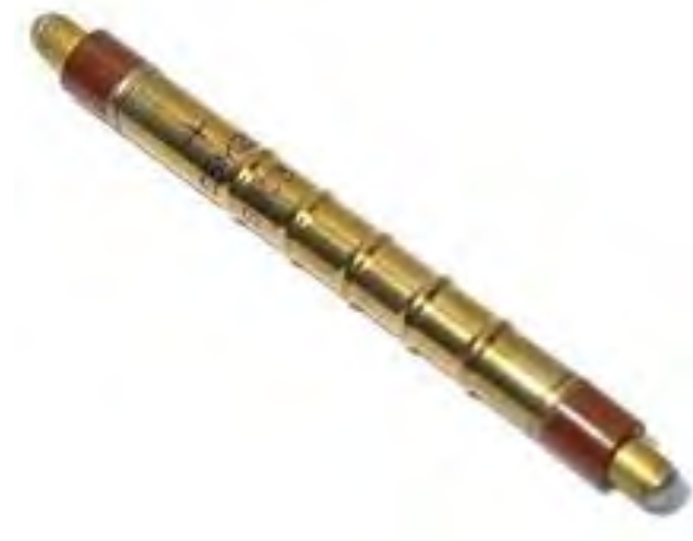
Рисунок 2.1 Трубка Гейгера СБМ-20
