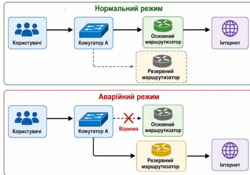
Рис. 1.1 — Принцип перемикавання трафіку на резервний шлях
