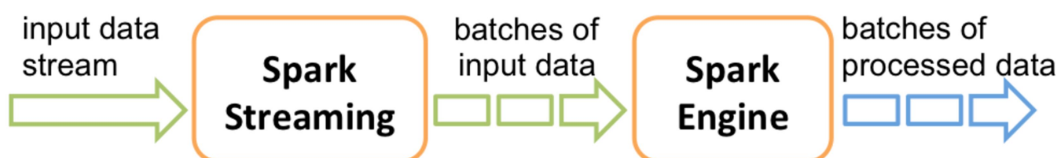
Рисунок 3.2 – Візуалізація потоку даних в Spark Streaming
