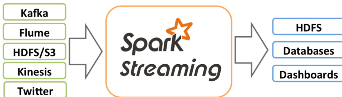
Рисунок 3.1 – Архітектура Spark Streaming
