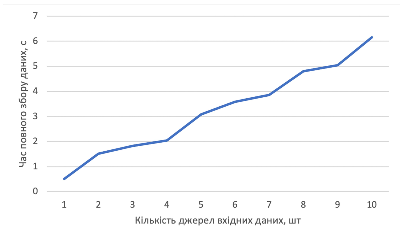
Рисунок 4.3 – Графік залежності часу повного збору даних від кількості джерел вхідних даних
