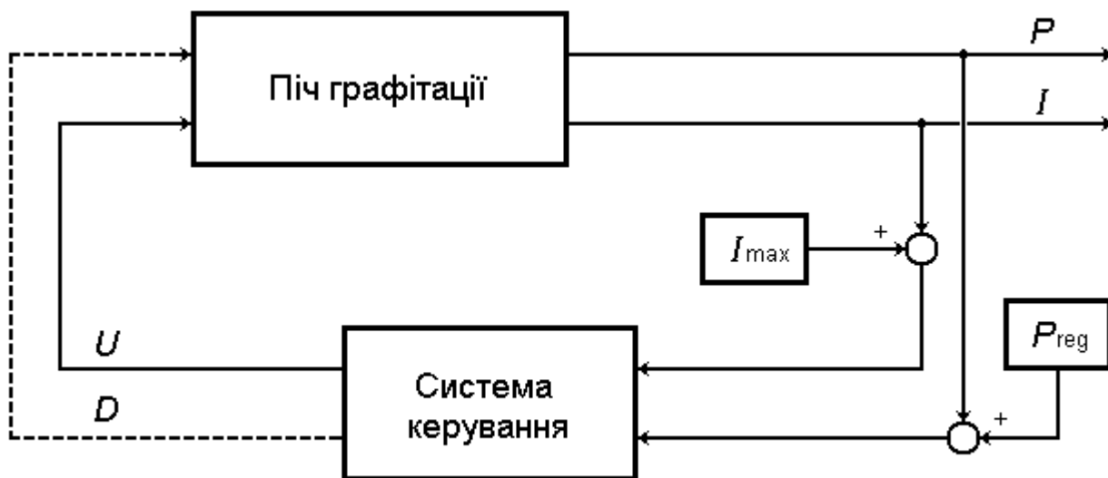
Рис. 1.7. Традиційна схема керування піччю графітації
