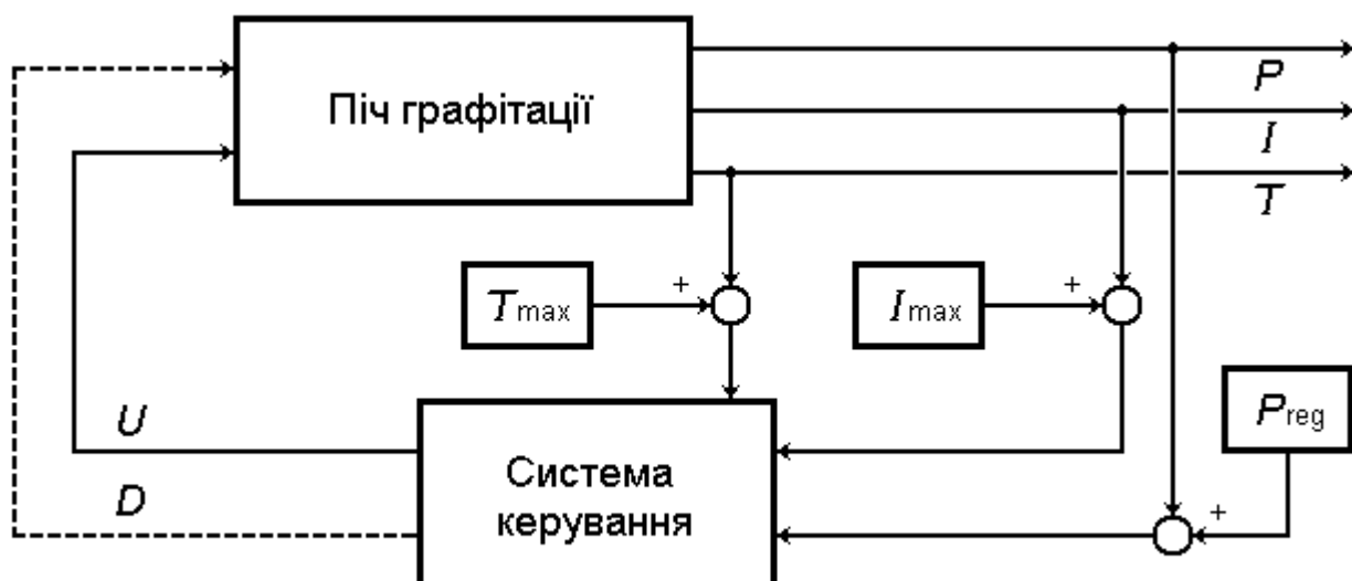
Рис. 1.8. Схема керування піччю графітації за температурою
