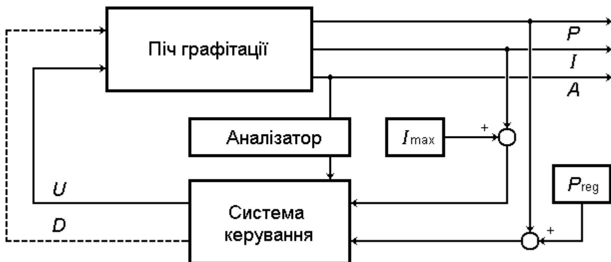
Рис. 1.9. Схема керування піччю графітації за акустичними сигналами
