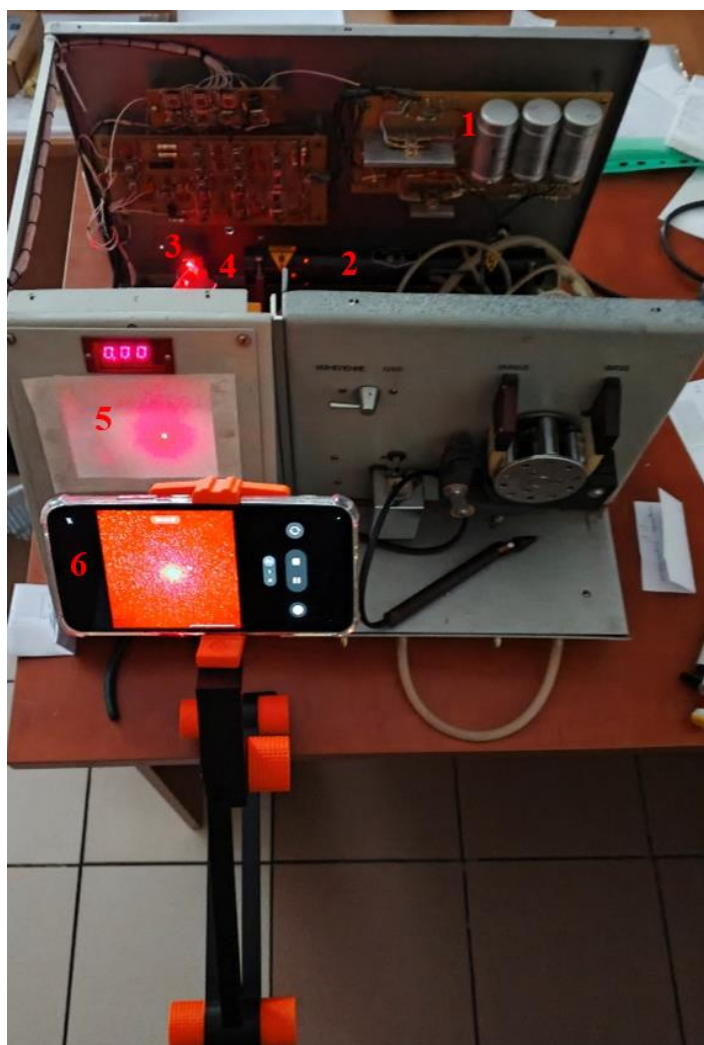
Рис. 2.1 – Лабораторний макет оптико-електронної установки аналізу показників гемостазу: 1 – блок керування та живлення, 2 – газовий He-Ne лазерний модуль ЛГН-207А, 3 – прямокутна призма, 4 – вимірювальна кювета,
