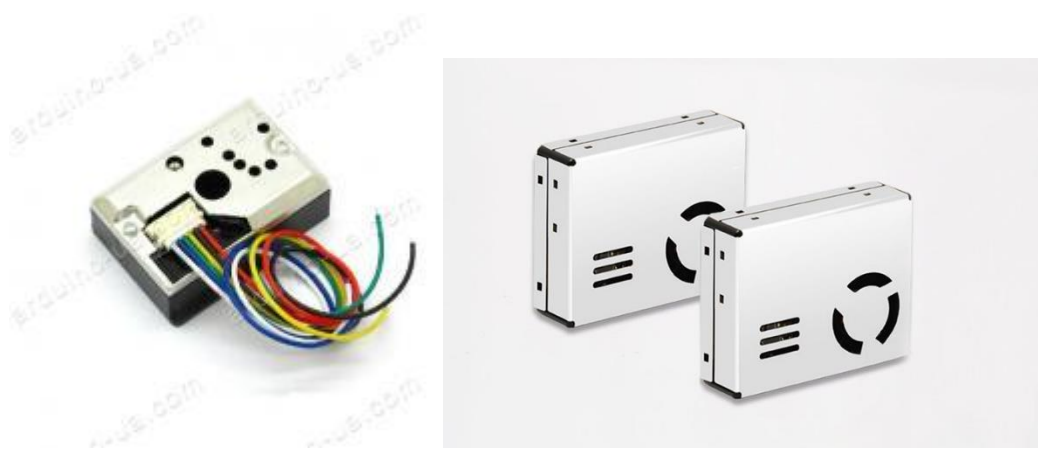
Рис. 1.11. Оптичний та лазерний датчики пилу та диму
