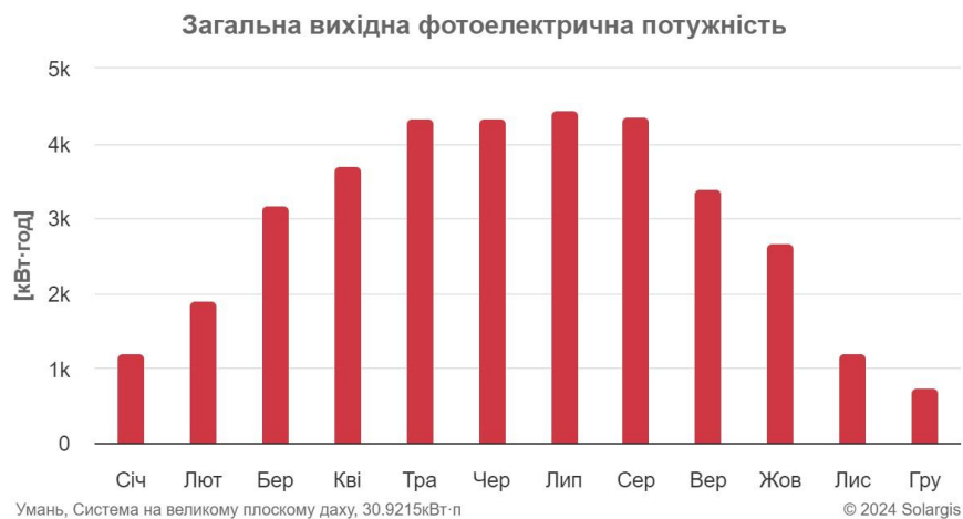
Рисунок 3.11 – Генерація СЕС протягом року у вигляді графіка (побудовано за допомогою програми Solargis) [22]
