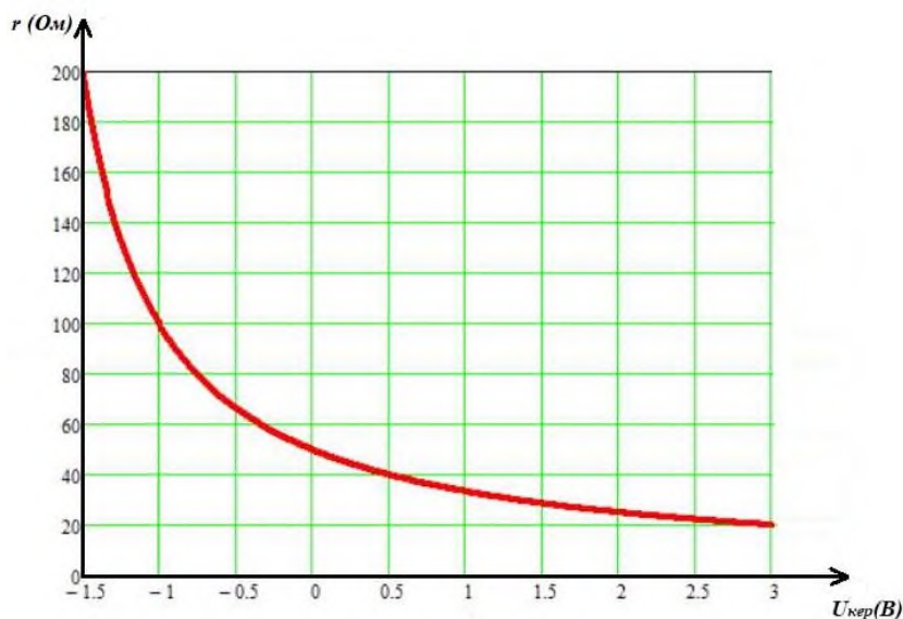
Рис. 2.13 Залежність опору польового транзистора JFET з каналом n-типу ввімкненого як VCR від керуючої напруги у всьому діапазоні опорів для транзистора VCR2N(20-200Ω).
