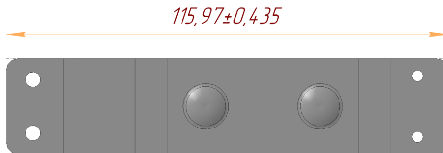
Рисунок 1.6 – Розгортка деталі «кронштейн фіксуєчий», виконана в програмі.
