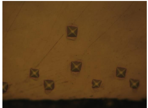
Рис. 4.7. Мікротвердість зразків зі сталі 45 після вібраційного обкатування
