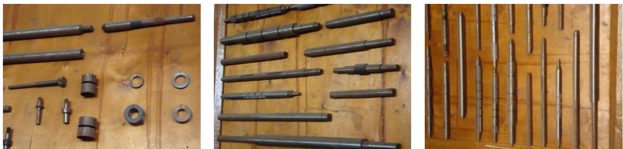
Рис. 1.6. Деякі циліндричні деталі післядрукарського обладнання, в яких виявлене зношування
