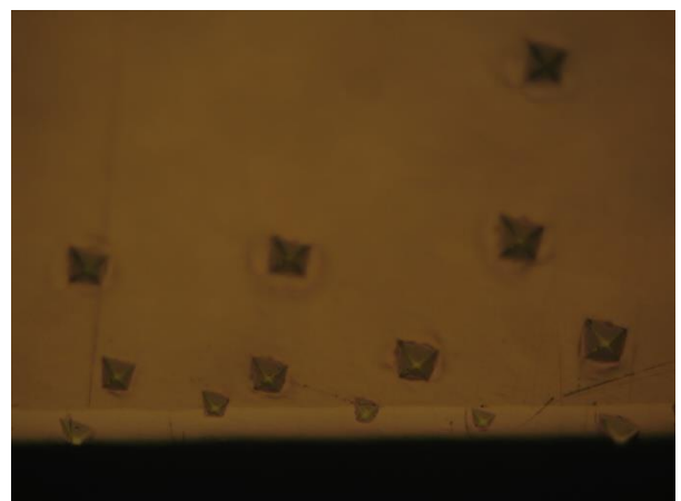
Рис. 4.8. Мікротвердість зразків зі сталі 45 після комплексної технології
