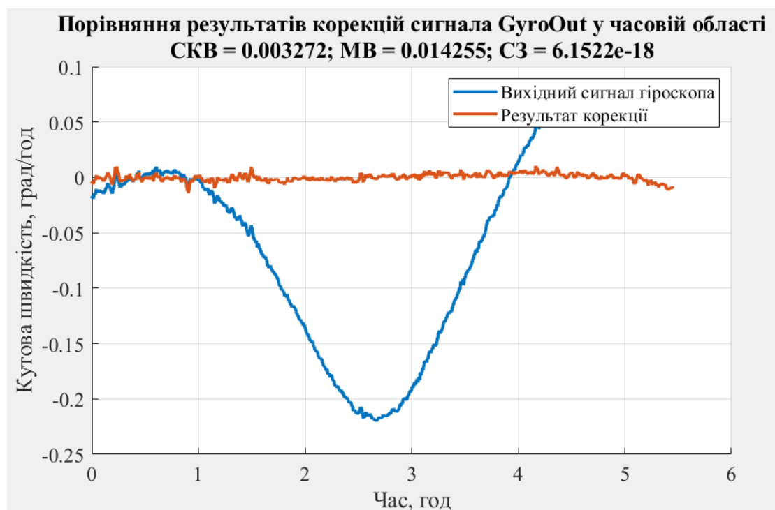
Рис. 3.42 - Результат компенсації вихідного сигналу по характеристиці GyroOut/Q_PID_Out, використовуючи поліном 3-го степеня, в часовій області.
