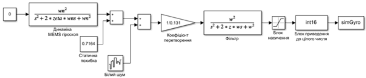
Рис. 3.9 - Модель Simulink гіроскопа рівня нульової швидкості
