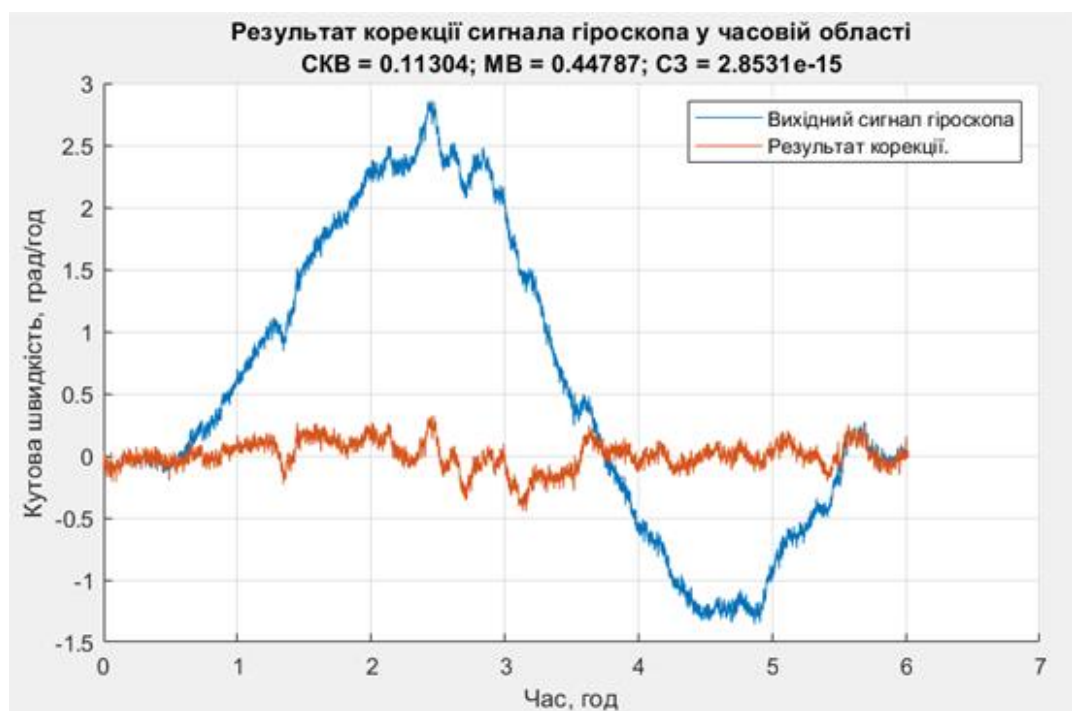
Рис. 3.23 - Результат компенсації вихідного сигналу використовуючи поліном 7-го степеня в часовій області
