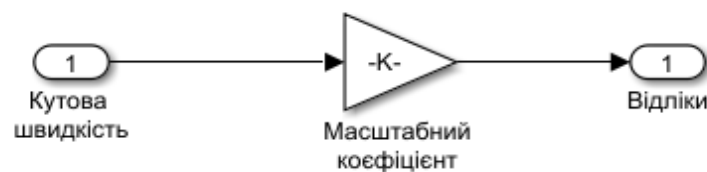
Рис. 3.1 – Примітивна модель гіроскопа
