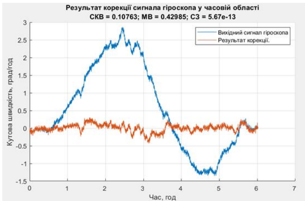
Рис. 3.25 - Результат компенсації вихідного сигналу використовуючи поліном 10-го степеня в часовій області
