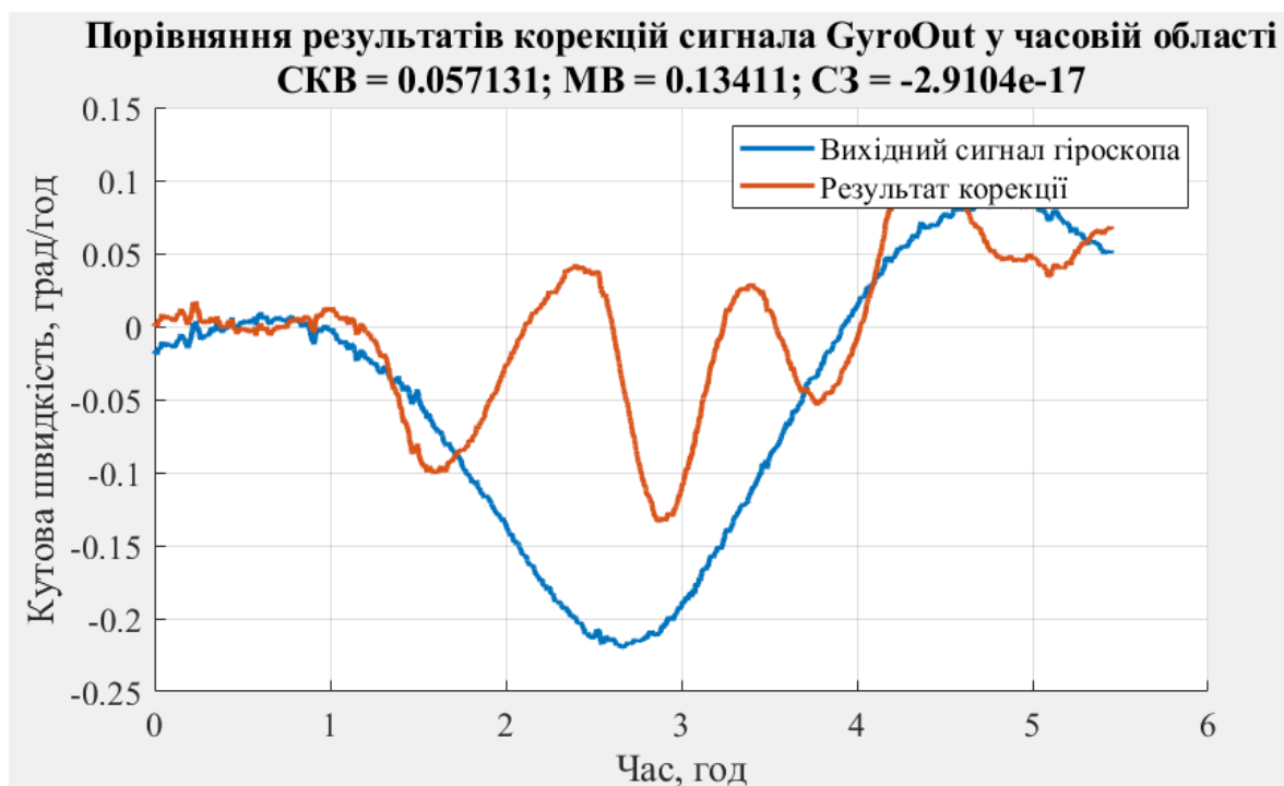
Рис. 3.40 - Результат компенсації вихідного сигналу по характеристиці GyroOut/A_PID_Out, використовуючи поліном 3-го степеня, в часовій області.
