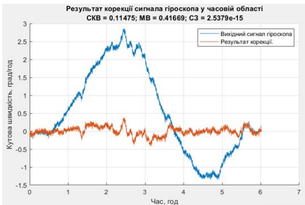
Рис. 3.21 - Результат компенсації вихідного сигналу використовуючи поліном 5-го степеня в часовій області
