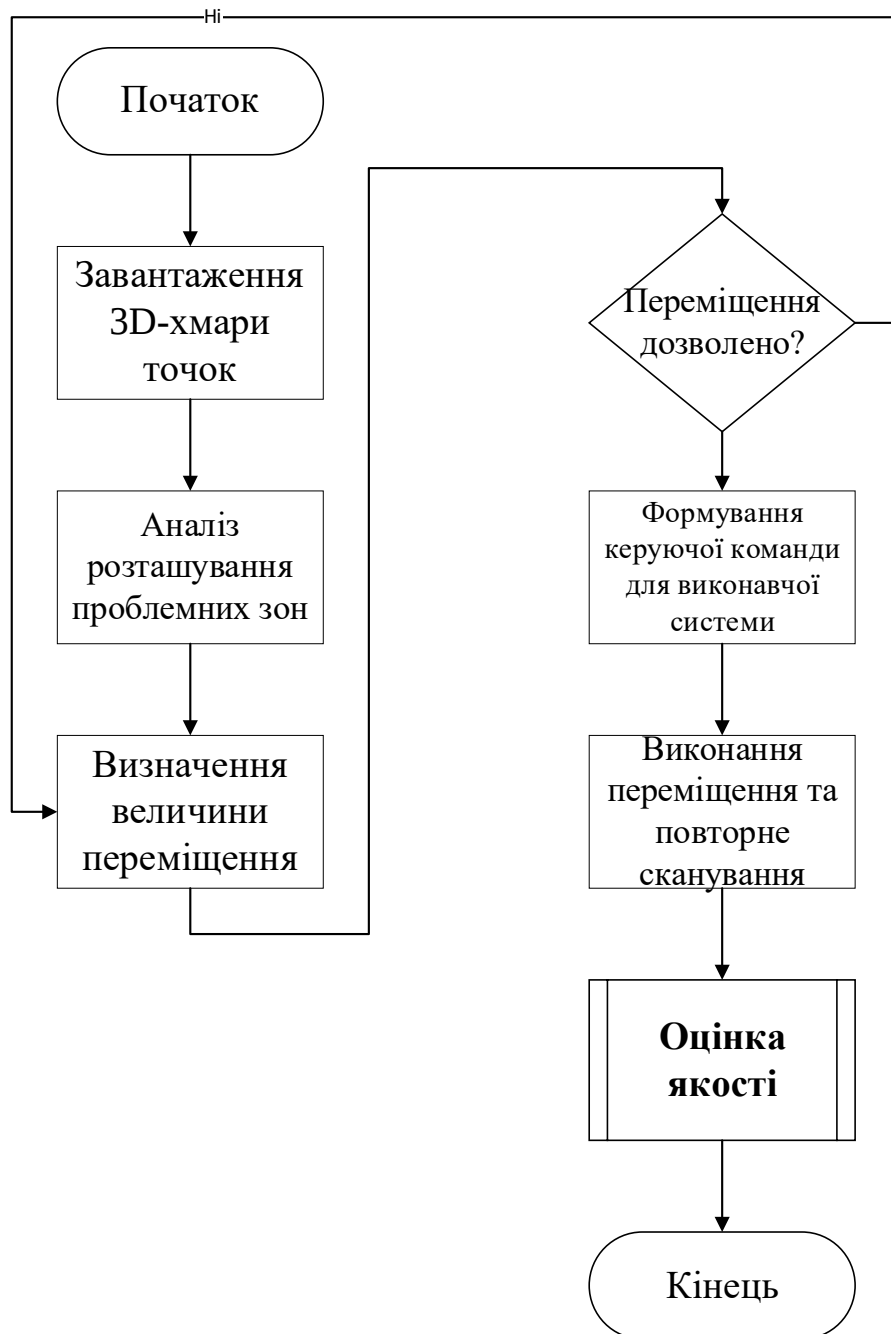
Рисунок 4.2 – Алгоритм адаптивного переміщення 3D-сканера
