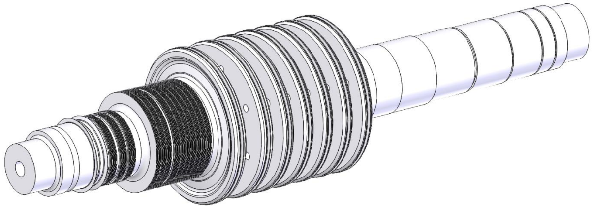
Рис. 3.1. Геометрична модель ротора середнього тиску турбіни К-200-130 блоку
