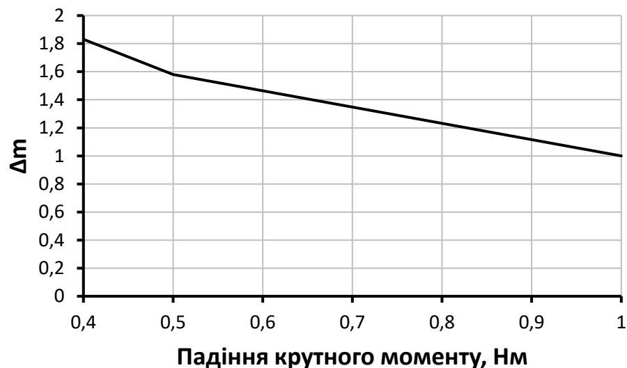
Рисунок 2.5 – Вплив падіння крутного моменту на падіння маси валу \Delta m .
