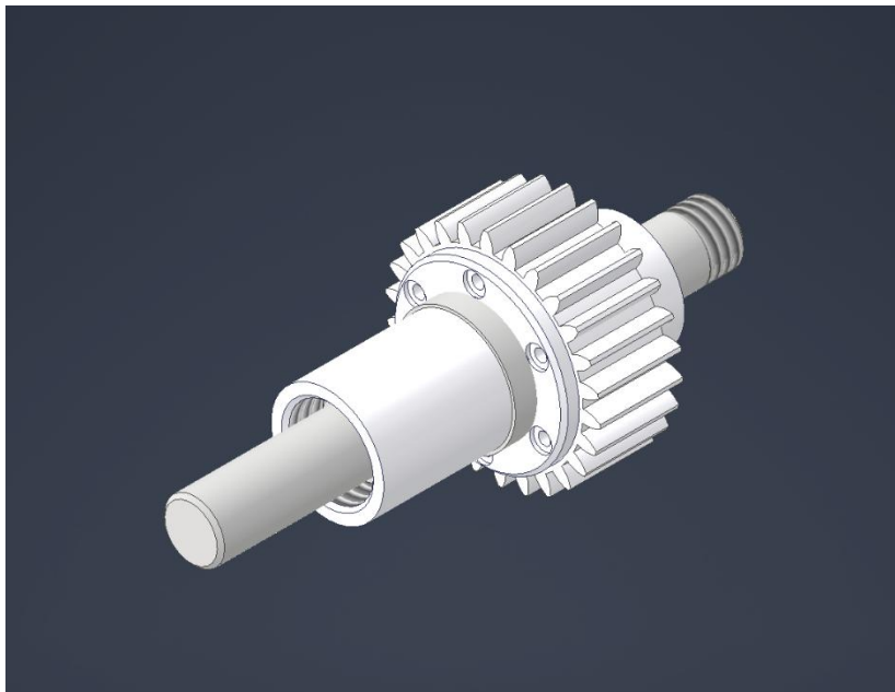
Рисунок 4.2 – Гвинт-гайка розміщена всередині зубчатого колеса жорстким зчепленням.
