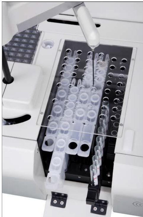
Рисунок 1.4.2.4 - Станція відбору зразків пацієнтів та реагентів аналізатора MAGLUMI 600 з 2 доріжками для штативів зі зразками та 4 доріжками для Лотків з системно-розташованими реагентами
