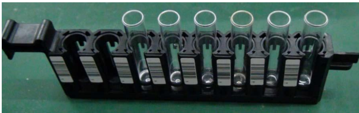
Рисунок 1.4.2.1 - Приклад штативу для зразків, розрахований на 8 зразків
