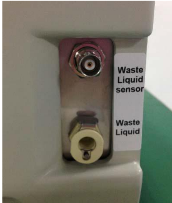
Рисунок 1.3.9.1 - Дренажні трубки для рідких відходів з правого боку аналізатора
