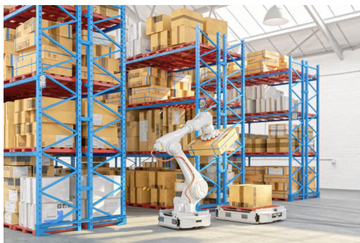
Рисунок 1.6. Мобільний маніпулятор у парі з мобільною платформою. [15]
