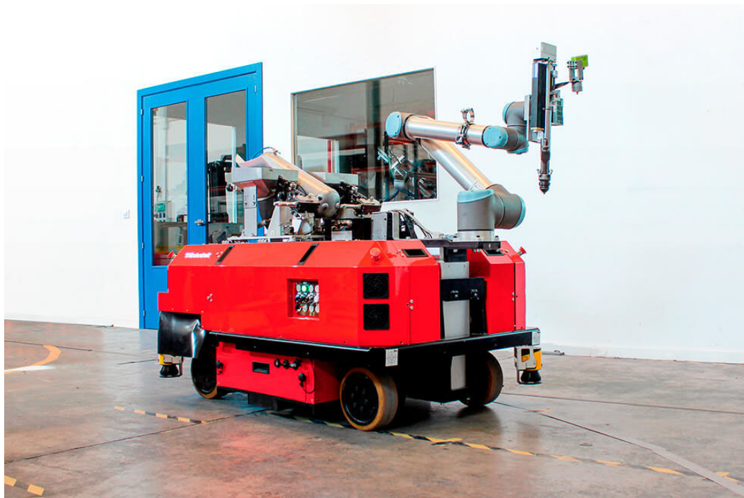
Рисунок 1.2. Мобільний маніпулятор RB-Vulcano, розроблений компанією Robotnik. [8]
