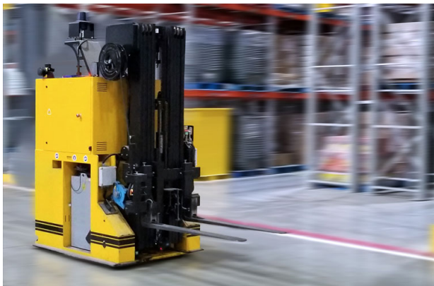
Рисунок. 1.1. Автоматично керовані транспортні засоби, які оперують у складських приміщеннях: а – автоматичні вантажні підйомники, розроблені компанією PeakLogic [6], б – вантажний робот SqUID, розроблений BionicHIVE [7]
