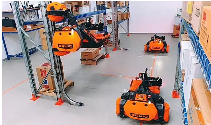
Рисунок. 1.1. Автоматично керовані транспортні засоби, які оперують у складських приміщеннях: а – автоматичні вантажні підйомники, розроблені компанією PeakLogic [6], б – вантажний робот SqUID, розроблений BionicHIVE [7]
