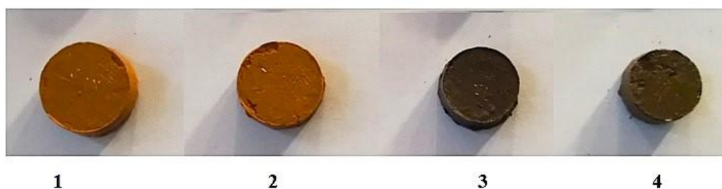
Рис. 1. Термооброблені зразки відпрацьованого сорбенту: 1- 950 °C; 2 - 1000 °C; 3- 1050 °C; 4 - 1100°C
