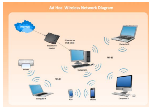
Рисунок 1.1 Діаграма ad-hoc мережі
