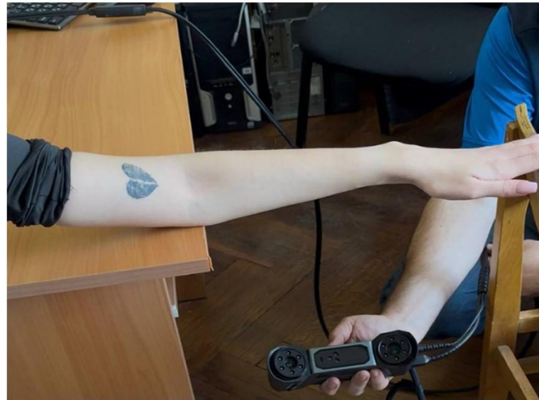
Сканування руки пацієнта портативним 3D-сканером без жорсткої фіксації.
