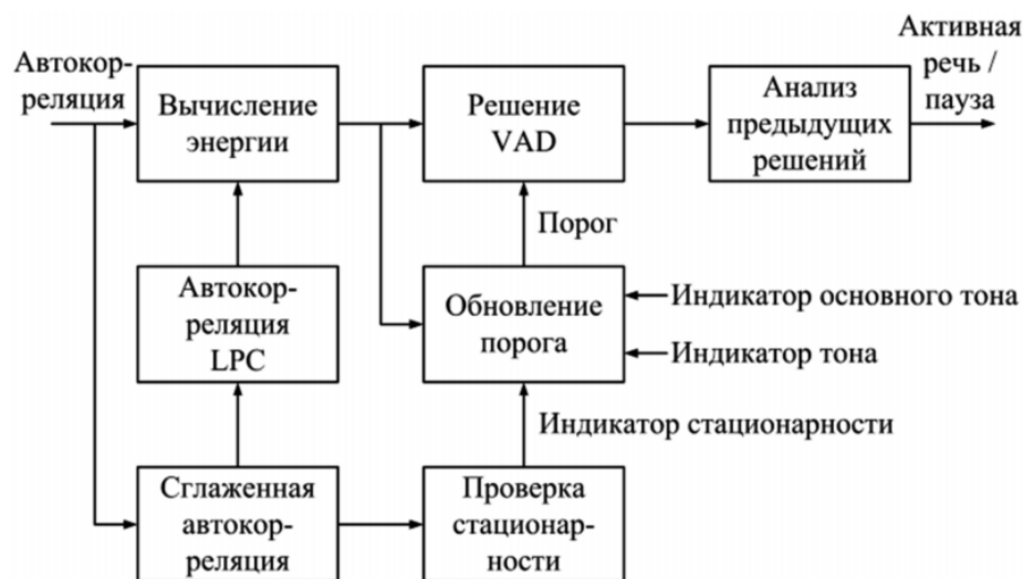
Рис. 2.2 Алгоритм VAD кодера GSM-EFR
