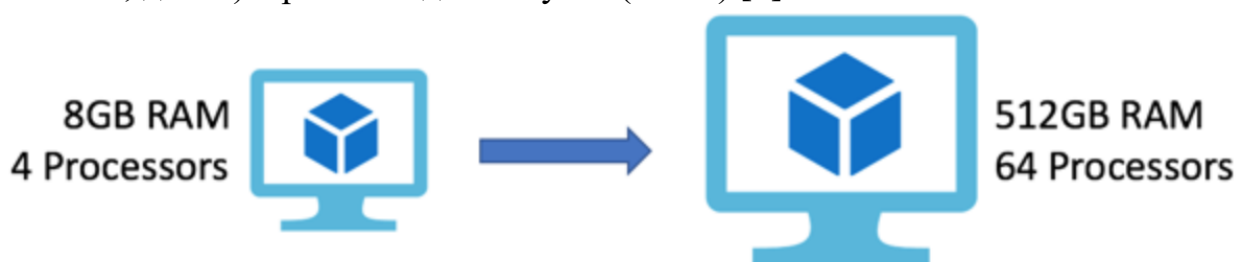
Рисунок 2.3. Принцип вертикального масштабування веб-додатку у хмарі.
