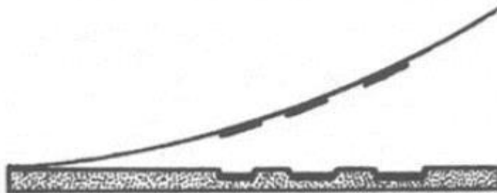
Рис.1.4. Зображення друкуючих та прорбільних елементів форми глибокого друку
