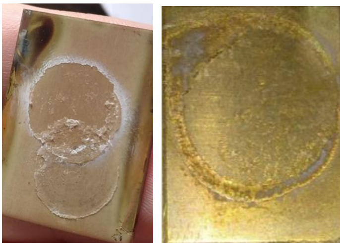
Рис. 3.2. Фото відриву грибка адгезиметром 8 МПа, (ліворуч) більше 10 МПа(праворуч)
