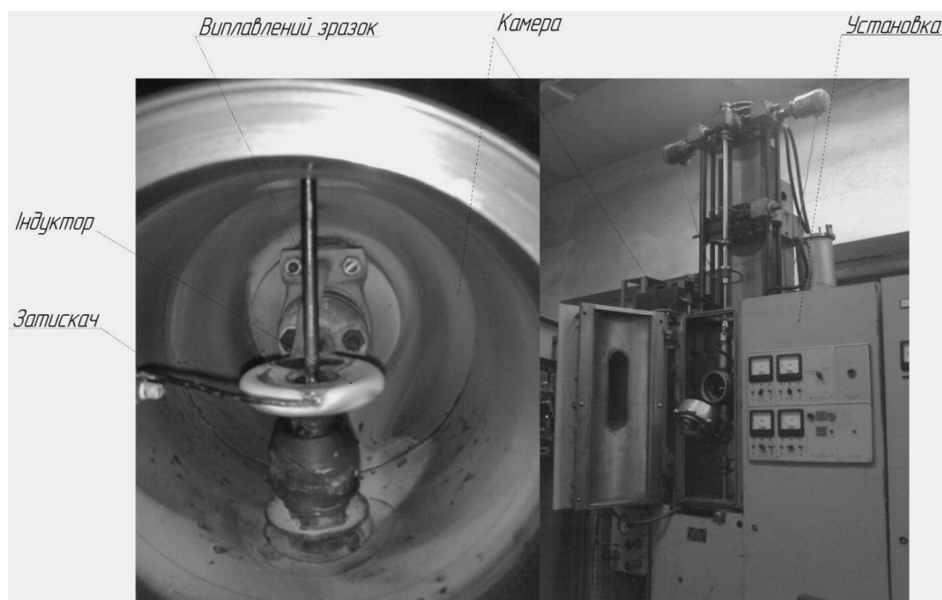
Рисунок 2.4 – Конструкція установки "Кристал-206"
