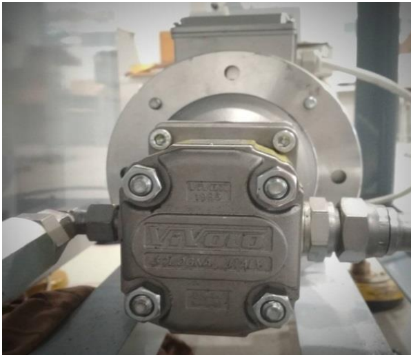
Рис. 2.3 Шестеренний гідронасос Н1 типу X2P4102EBBA.
