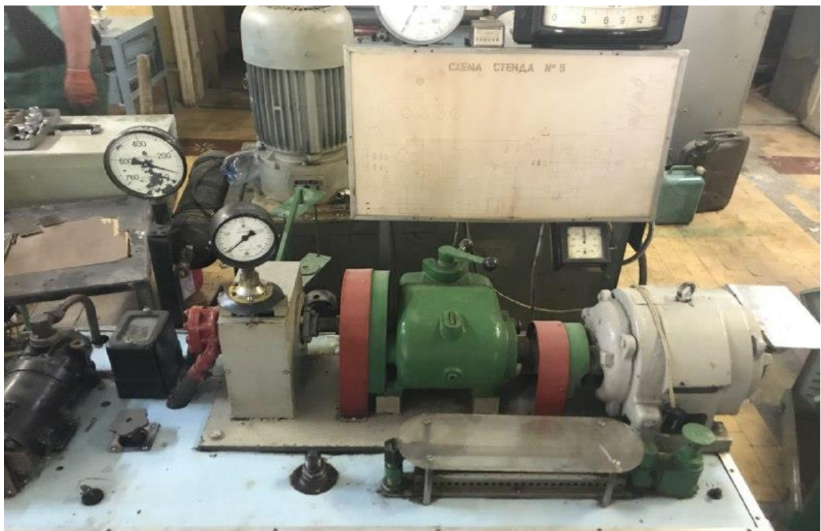
Рис 1.4. Стенд для випробування шестеренного насоса
