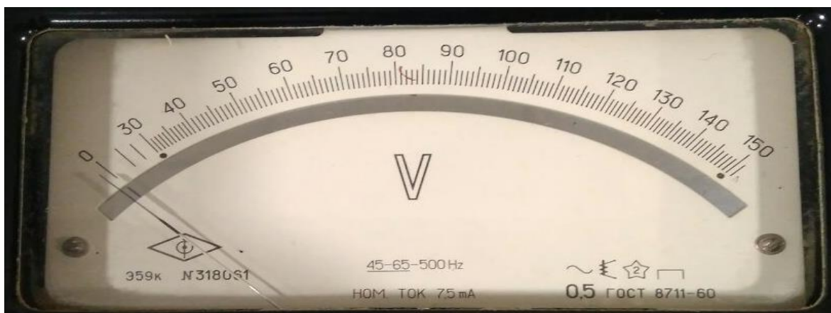
Рис.2.36 Вольтметр загальний вигляд.
