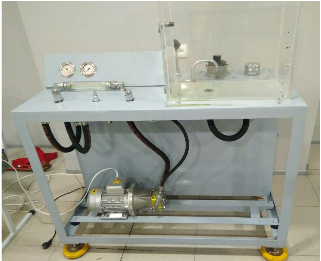
Рис.3.2 Стенд для випробування шестеренного насосу.
