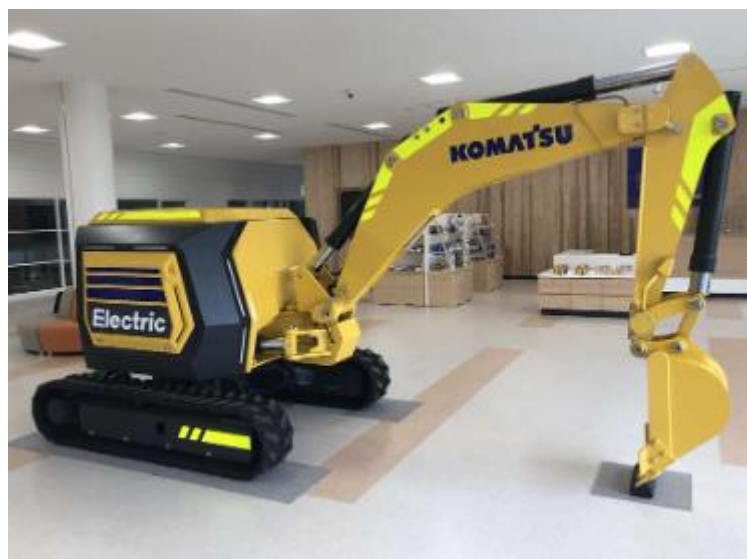
Рис.1.5 Приклад автоматизованого виконання будівельної техніки, концептуальний електричний екскаватор з дистанційним керуванням від Komatsu[15]
