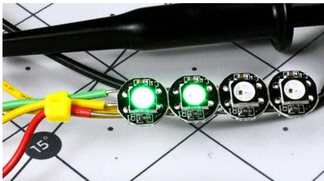
Рис. 26. Два світлодіоди WS2812b після отримання керуючої послідовності, показаної на рис. 25
