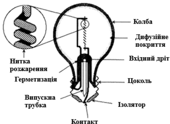
Рис. 1. Будова лампи розжарювання
