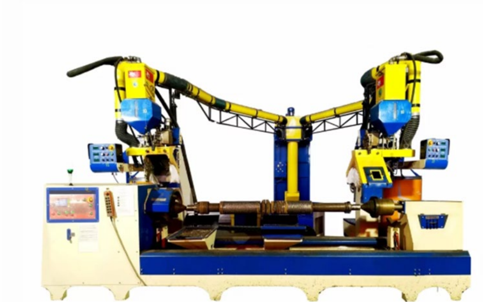
Рисунок 2.3 – Установка для наплавки валков прокатного стана AC354-7000-2
