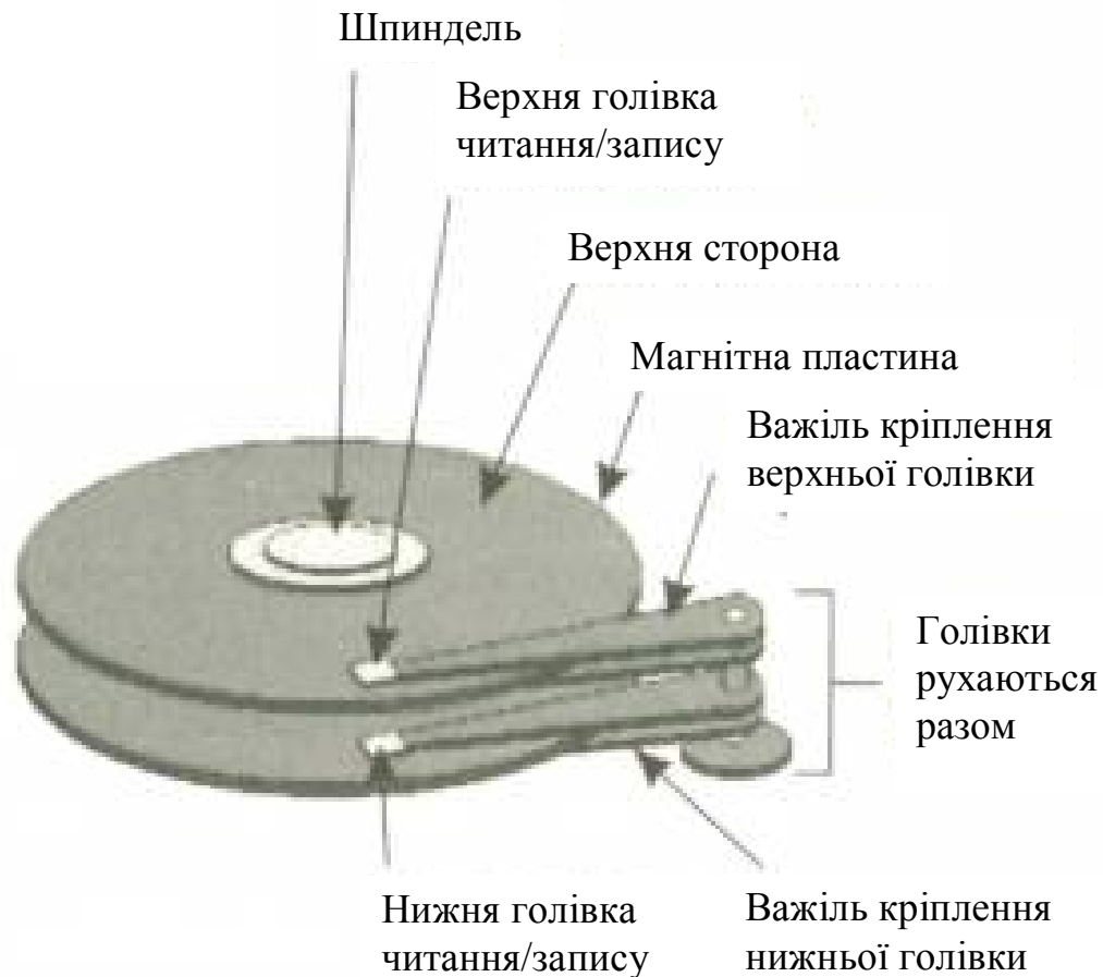
Рисунок 1.3 – Основна механічна структура та компоненти жорсткого диска [8]
