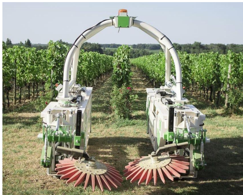
Рисунок 1.15 - Робот-виноградар Ted [ https://www.naio-technologies.com/ ]
