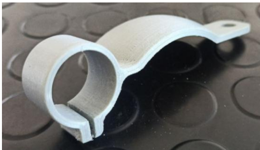
Рисунок 3.18 - Результат виготовлення деталі “Кріплення лазера”
