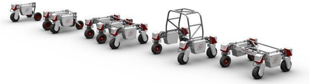
Рисунок 1.19 - Модулі Thorvald II. Зліва-направо: низька вузька версія для теплиць, триколісна версія, версія з диференціальним приводом, висока версія для фенотипування, стандартна версія [12]
