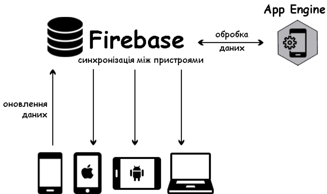
Рис. 2.4 – Схема взаємодії Firebase з пристроями
