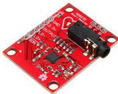
Рисунок 3.1 – Модуль AD8232 для реєстрації біопотенціалів
