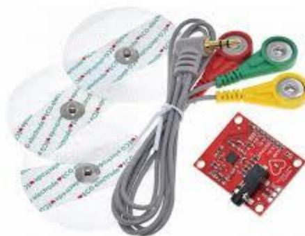
Рисунок 3.6 – Модуль реєстрації біопотенціалів AD8232 з електродами
