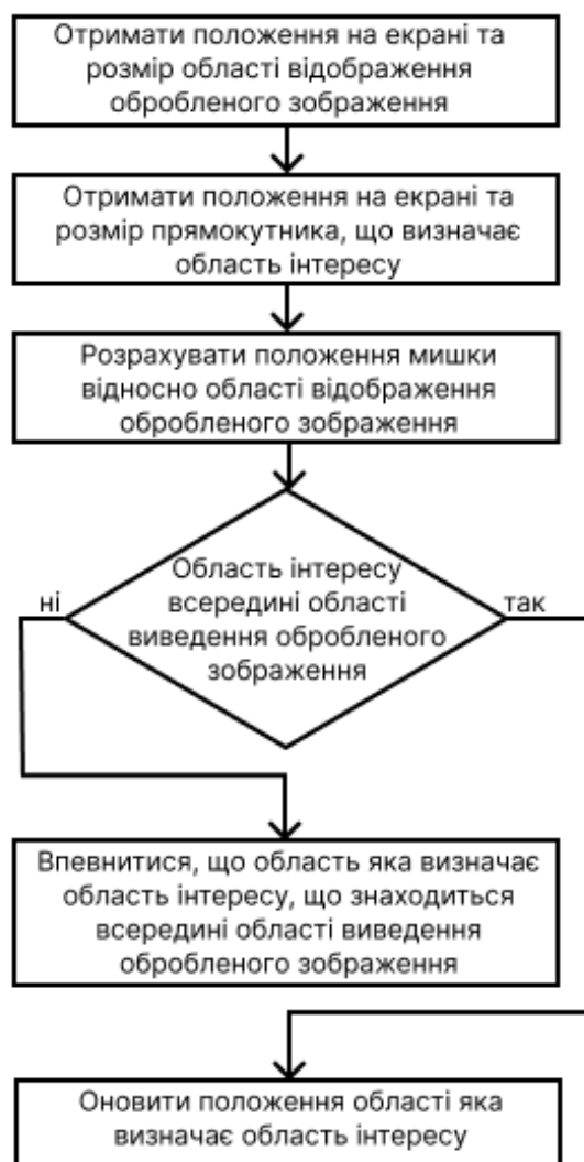
Рисунок 3.6 – Блок схема коду, що визначає область наближення
