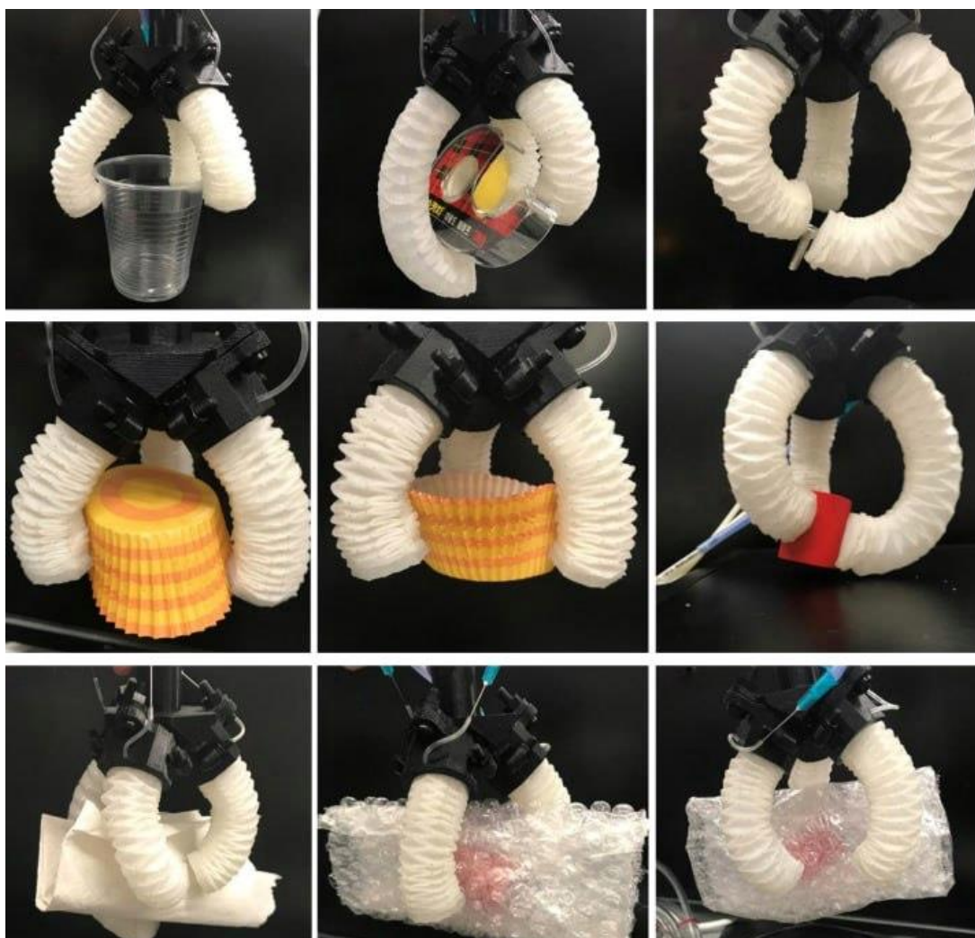
Рисунок 1.5 – Маніпулятор з еластичним елементом [7]
