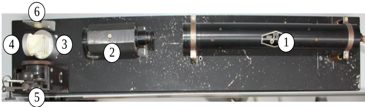
Рис. 2.10. Загальний вигляд інтерферометру Майкельсона : 1 – лазер, 2 – телескопічна система, 3 – світлорозділююча призма, 4 – дзеркало, 5 – юстующе дзеркало, 6 – лінза.
