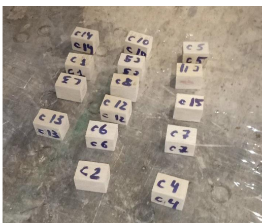
Рисунок 3.2.1 Зразки для дослідження властивостей матеріалу на стиск
