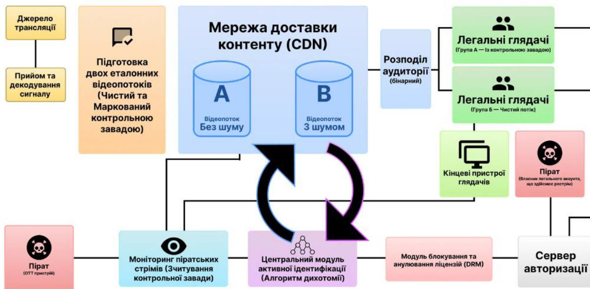
Рисунок 1.1 — Структурна схема модифікованої системи захисту комерційних прямих трансляцій.
