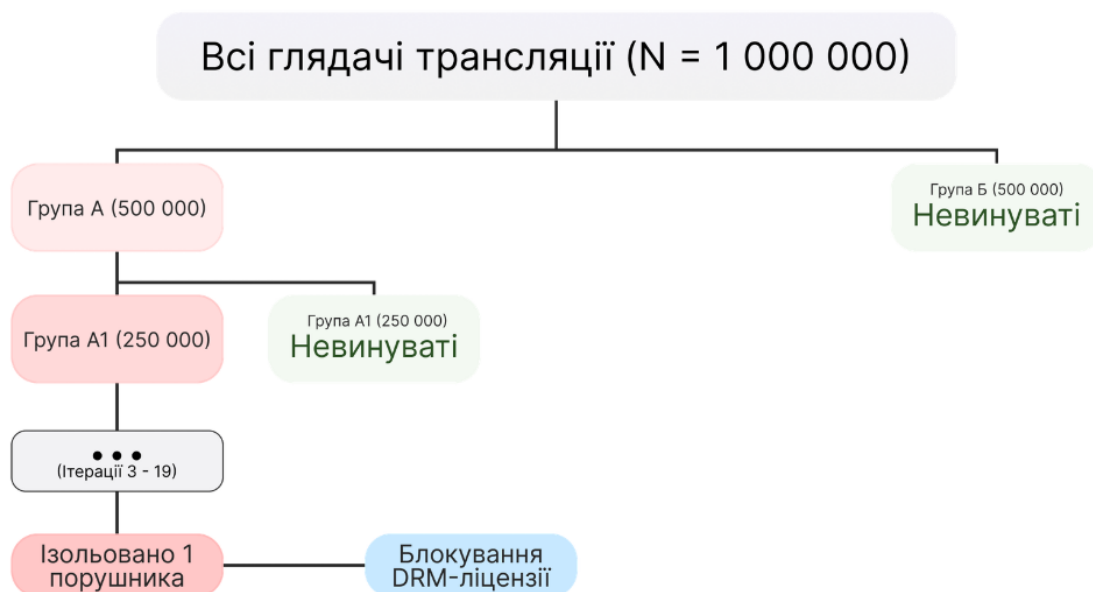
Рисунок 4.1 — Дерево пошуку (дихотомія) для ізоляції джерела витоку.
