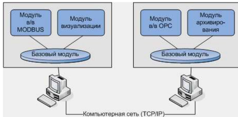
Рис. 3. Структура системи диспетчеризації, що складається із чотирьох модулів, розташованих на двох комп'ютерах
