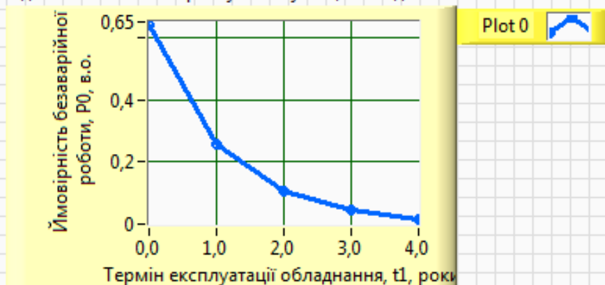
Рисунок 5.1. – Контрольна панель віртуального приладу для досліджень по встановленню терміну безаварійної роботи обладнання
