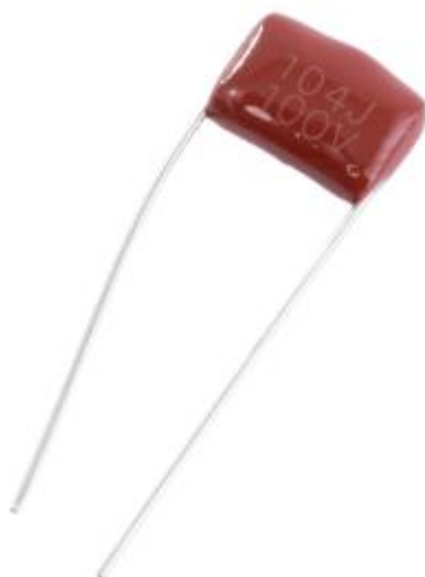
Рисунок 2.7 – Плівковий конденсатор 100 нФ, 100 В, Hitano
