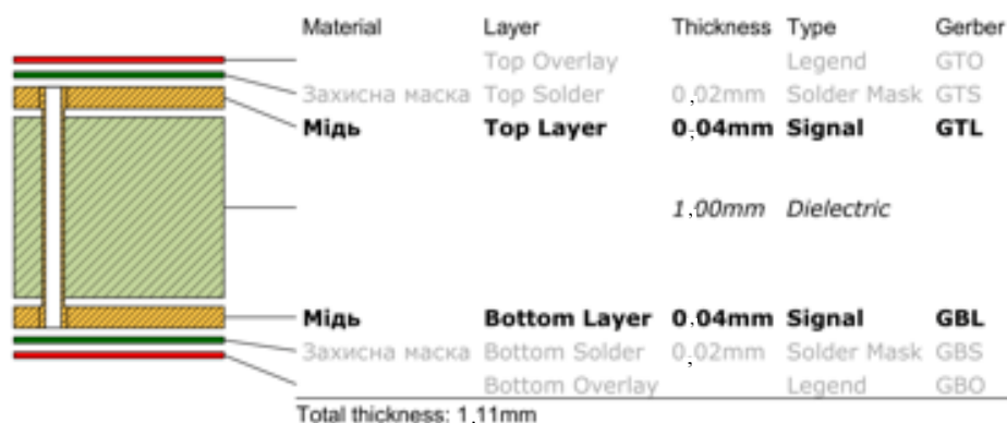
Рисунок 3.1 – Конструкція плати по-шарово
