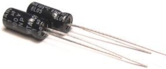
Рисунок 2.9 – неполярний електролітичний конденсатор 4.7 мкФ, 100 В, Hitano
