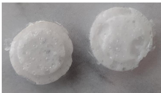
Рисунок 2.9 – Виготовлені мікроголки з ПВС
