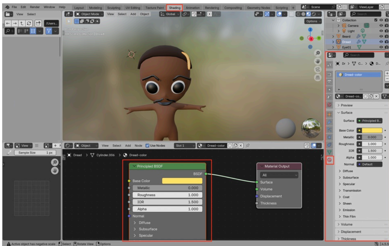
Рис. 1.31 – Створення та налаштування матеріалу 3D-об'єкта за допомогою редактора Shader Editor
