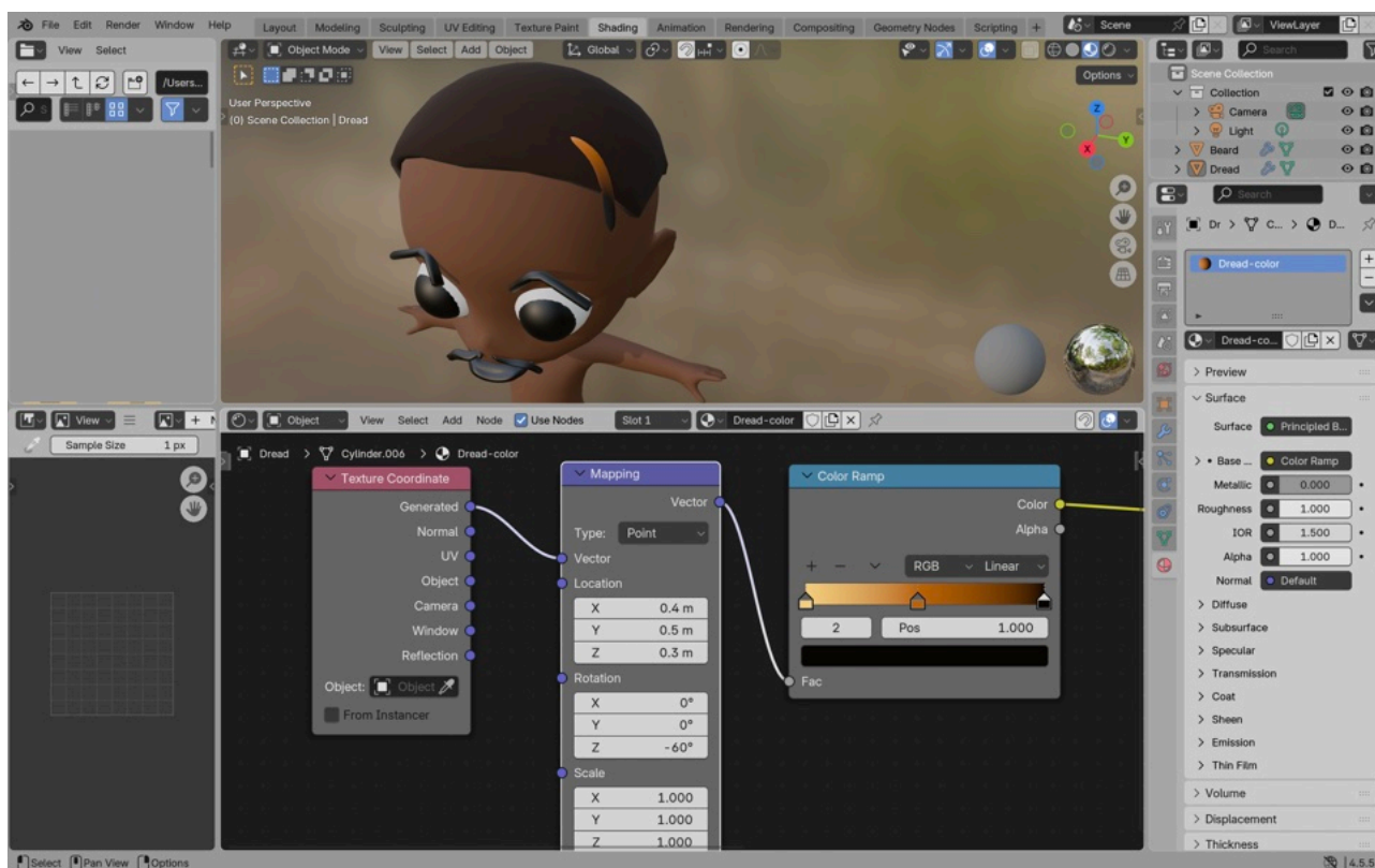
Рис. 1.34 – Налаштування вузлів картографування ( Mapping ) та координат текстури ( Texture Coordinate )
