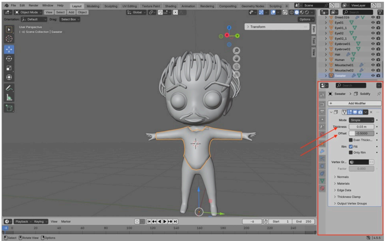
Рис. 1.26 – Налаштування модифікатора Solidify
