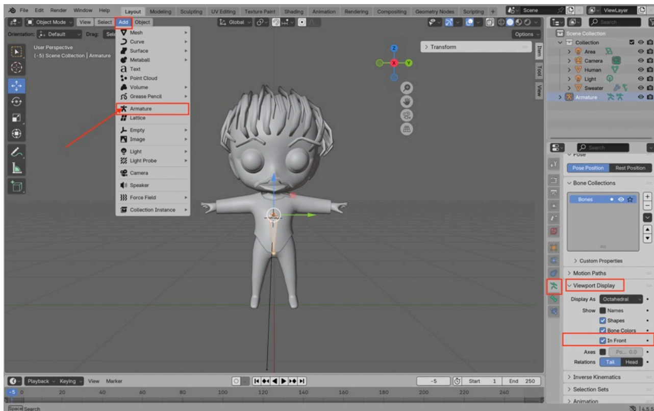
Рис. 1.36 – Додавання та налаштування відображення об'єкта Armature
