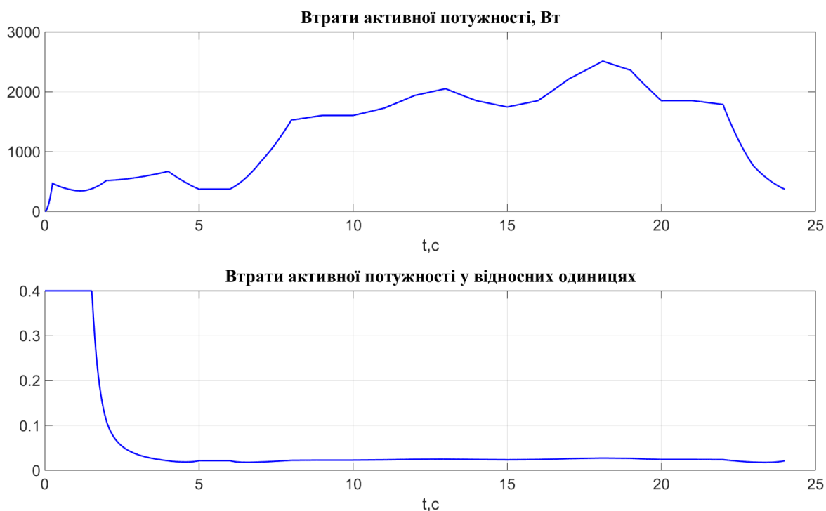
Рисунок 4.19 – Графік перехідних процесів втрат активної потужності( \Delta P_a ) та ( \Delta P_a(\%) ) при русі вгору у вихідний день
