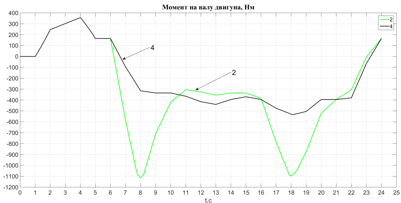
Рисунок 4.32 – Порівняння графіків перехідних процесів моменту на валу двигуна при різних режимах роботи у випадку руху ескалатора вниз
